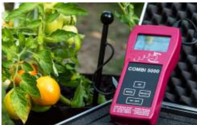
活性塩測定(塩分), 土壤水分(vol%)と温度を同時に測定できるマルチ電極
