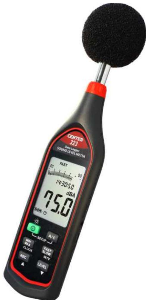
CENTER 323 は、64,000 メモリーを有するデータロガー機能付きの高精度な騒音計です。3 レンジ切替えて 30 ~ 130 dB までの騒音を ±1.4 dB の高精度で測定します。測定中の騒音は 0.1 dB 単位での数値表示とバーグラフで表示します。
